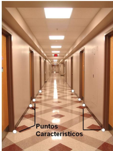
Figura 1-1: Puntos Característicos de un pasillo. El método de Invariantes Proyectivos utiliza estos puntos para determinar la posición del robot.
