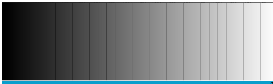
Figura 2.1: Imagen de todos los valores en la escala de grises. Las líneas divisorias agrupan valores cada 8 niveles de gris.
