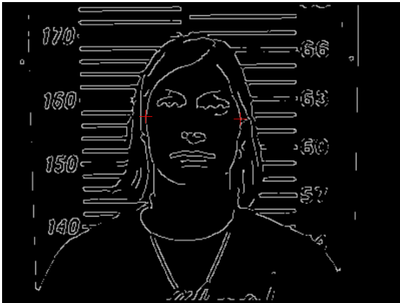
(c) Misma imagen luego de aplicarle el operador de Canny con valores de umbral alto y bajo 80 y 60 respectivamente. Medición entre las cruces: 14,8776 cm.
