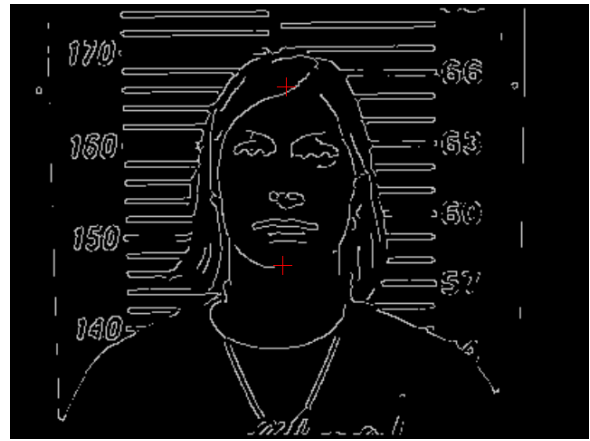
(b) Misma imagen luego de aplicarle el operador de Canny con valores de umbral alto y bajo 80 y 60 respectivamente. Medición entre las cruces: 19,407 cm.
