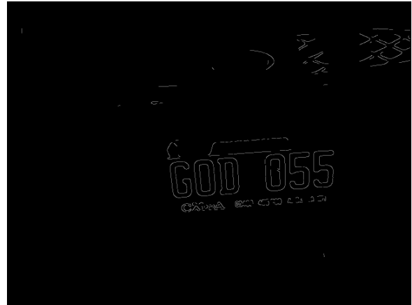
(b) Misma imagen luego de aplicarle el operador de Canny con valores de umbral alto y bajo 135 y 75 respectivamente.
