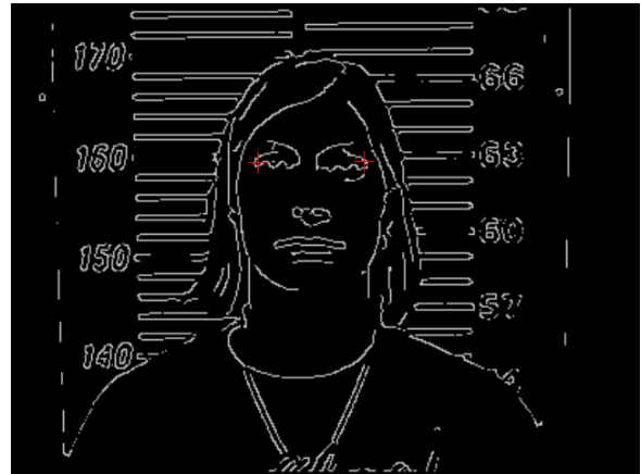
(f) Misma imagen luego de aplicarle el operador de Canny con valores de umbral alto y bajo 80 y 60 respectivamente. Medición entre las cruces: 10,6376 cm.
