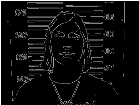
(e) Misma imagen luego de aplicarle el operador de Canny con valores de umbral alto y bajo 80 y 60 respectivamente. Medición entre las cruces: 5,02697 cm.
