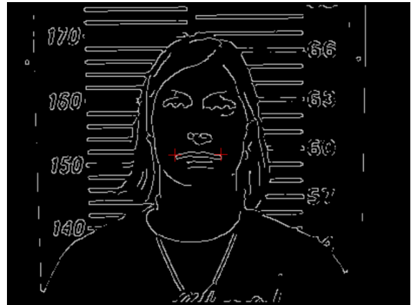
(d) Misma imagen luego de aplicarle el operador de Canny con valores de umbral alto y bajo 80 y 60 respectivamente. Medición entre las cruces: 7,19061 cm.
